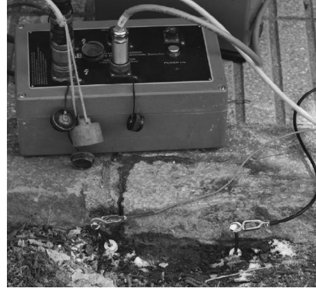
Fig. 1. Detalle de la utilización de pequeños clavos, humedecidos con agua y sal, como los electrodos de contacto. C/ de Santa Brígida de Amer (Girona).
