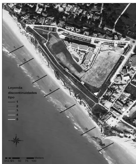
Fig. 3. Mapa de las familias de discontinuidades observadas y división en tramos (representado sobre la foto aérea de 2009).
