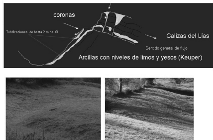
Fig. 2. Superior, corte geológico N-S de la ladera. Inferior, ejemplos de las tubificaciones localizadas.
