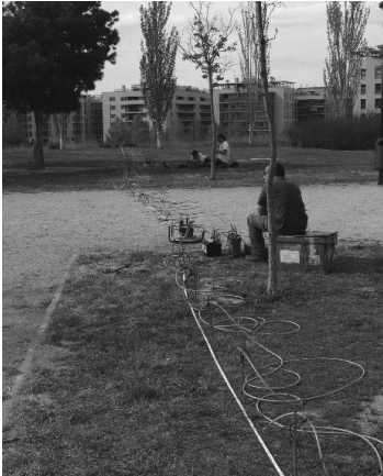
Fig. 4. Toma de datos en Vistabella, Zaragoza. Dispositivo DDP con espaciados interelectródicos de 1m.
